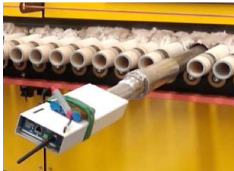
Figure 3.16. Mesure des gradients transversaux de température avec un rouleau à captation.
