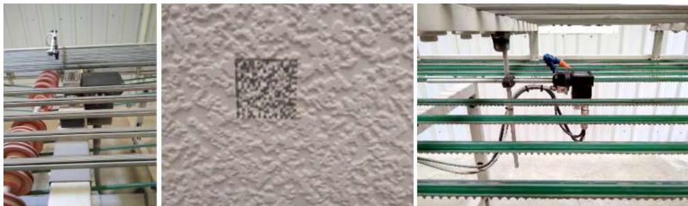
Figure 3.7. De gauche à droite : tête d'impression pour le marquage des pièces, pièce codifiée et caméra de détection.
